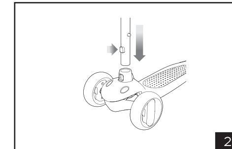
Достаньте самокат SK1O1 (или SK1O3) из коробки. В случае с SK1O1, отстегните ремень (рис.1), которым руль самоката прикреплен к нижней части деки (платформы). Надавите на кнопку, расположенную в нижней части руля, и вставьте его во втулку в деке (рис.2). Убедитесь, что руль зафиксирован в посадочном месте. Вытащить руль можно, надавив на эту же кнопку, и потянув его из втулки.
