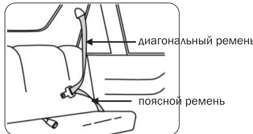
Данное автокресло может быть установлено только с использованием поясного и диагонального ремня безопасности на переднем или заднем сидении автомобиля, оборудованного трехточечными ремнями безопасности.
