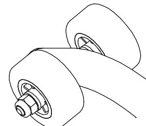
Чтобы установить колеса, наденьте на болт поочередно шайбу, колесо, шайбу. Потом проденьте свободный конец болта в отверстие, расположенное в задней части полозьев, и снова поочередно наденьте шайбу, колесо, шайбу. Закрепите колеса на полозьях при помощи гайки. Выбирайте уместную степень затяжки гайки, так чтобы колеса крутились свободно.
